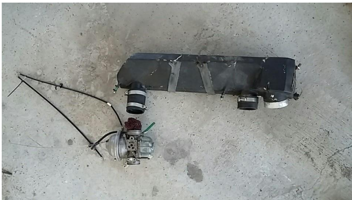
Sací komora s filtrem, který do ní byl nasán.
