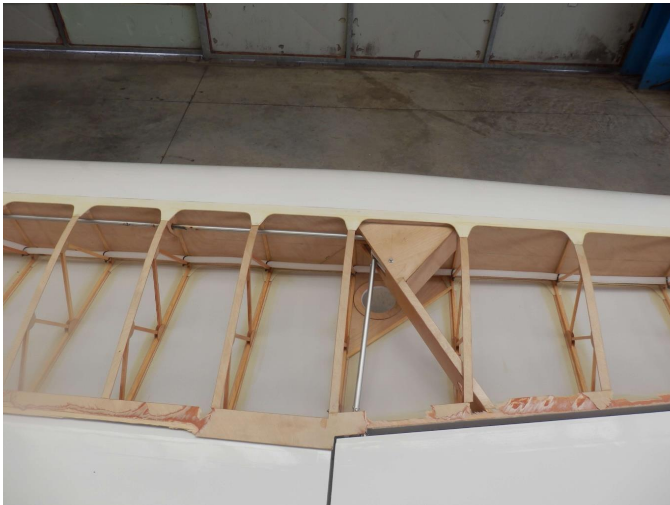
Obr.3: Održený potah z horní části pravého křídla
