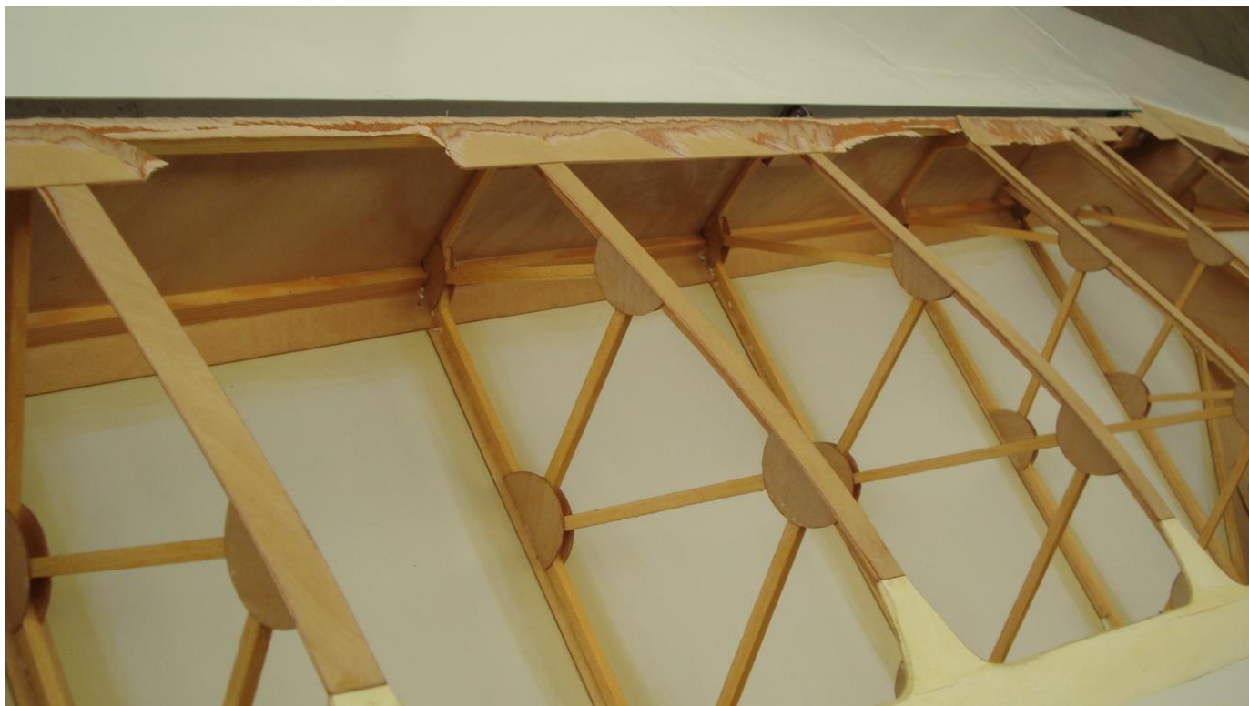
Obr.2: Odtržený potah z horní části křídla
