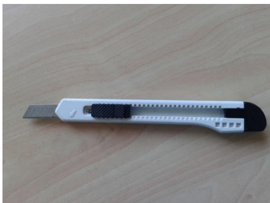
Obr.1: vhodný nástroj na kontrolu přilepení potahu
