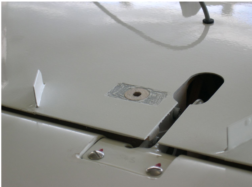
Krok 4. - Vlepení překližkového kroužku do otvoru d16
