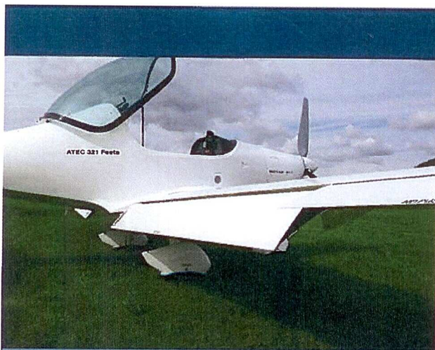
Med flaps i position 3 er den anbefalede anflyvningshastighed 49 kt (90 km/t) med en tærskelhastighed på 80 km/t. Men flere af testpiloterne bemærker, hvor glat flyet er. Har man for meget fart på, får man sig en overraskelse, for maskinen fortsætter meget langt i ground effect.
