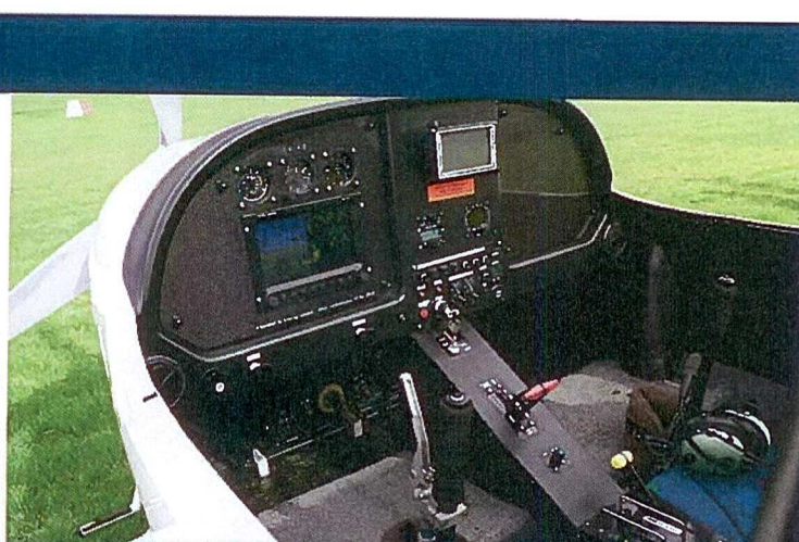
Et enkelt og logisk cockpit udrustet med Dynons prisbillige Skyview-glascockpit.
