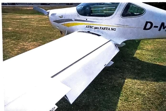
Die Spaltklappen fahren elektrisch in drei Stufen aus.
