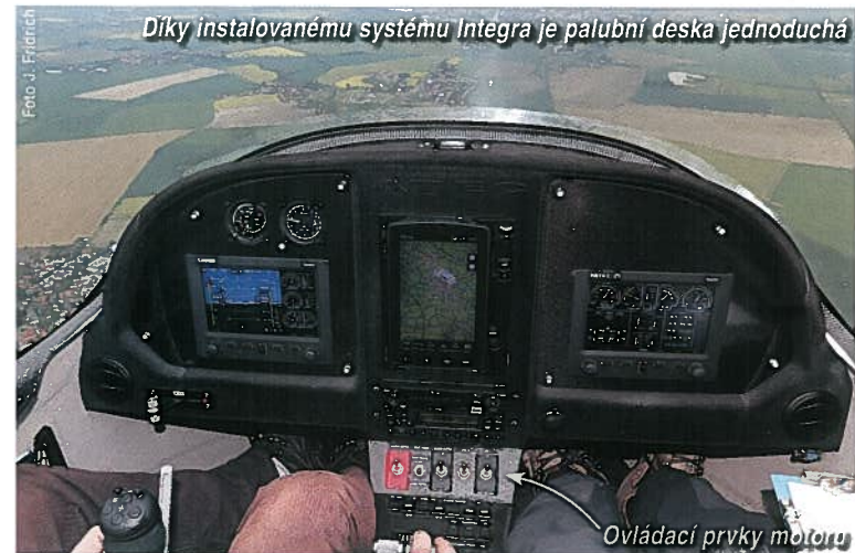
Ventilátor pro ofukování skla kabiny Tlačítko startování motoru
