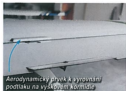
Ovládání vyvažovací plošky modelářským servem
