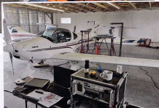
Fluttertesten blir utført ved at elektroniske sensorer og givere plasseres på begge vinger og rorflater, som så blir utsatt for svingninger som tilsvarer ulike hastigheter. Foto: Atec
