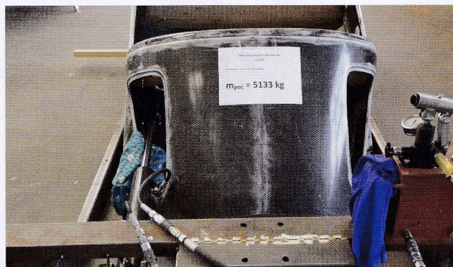
For innfestningen til redningsskjermen er kravet minimum 5133 kilo. For moro skyld ble denne seksjonen testet til 6290 kilo, som var det maksimale hydraulikken på test-jiggen klarte. Foto: Atec
