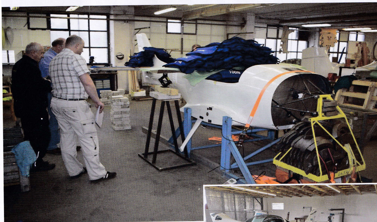
Test av flykroppen foregår med 3432 kilo fordelt over hele flyet. Foto: Atec
