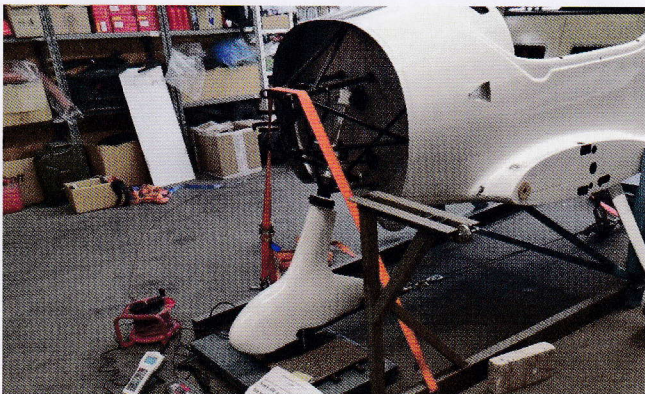
Også neseleggen testes. Foto: Atec
