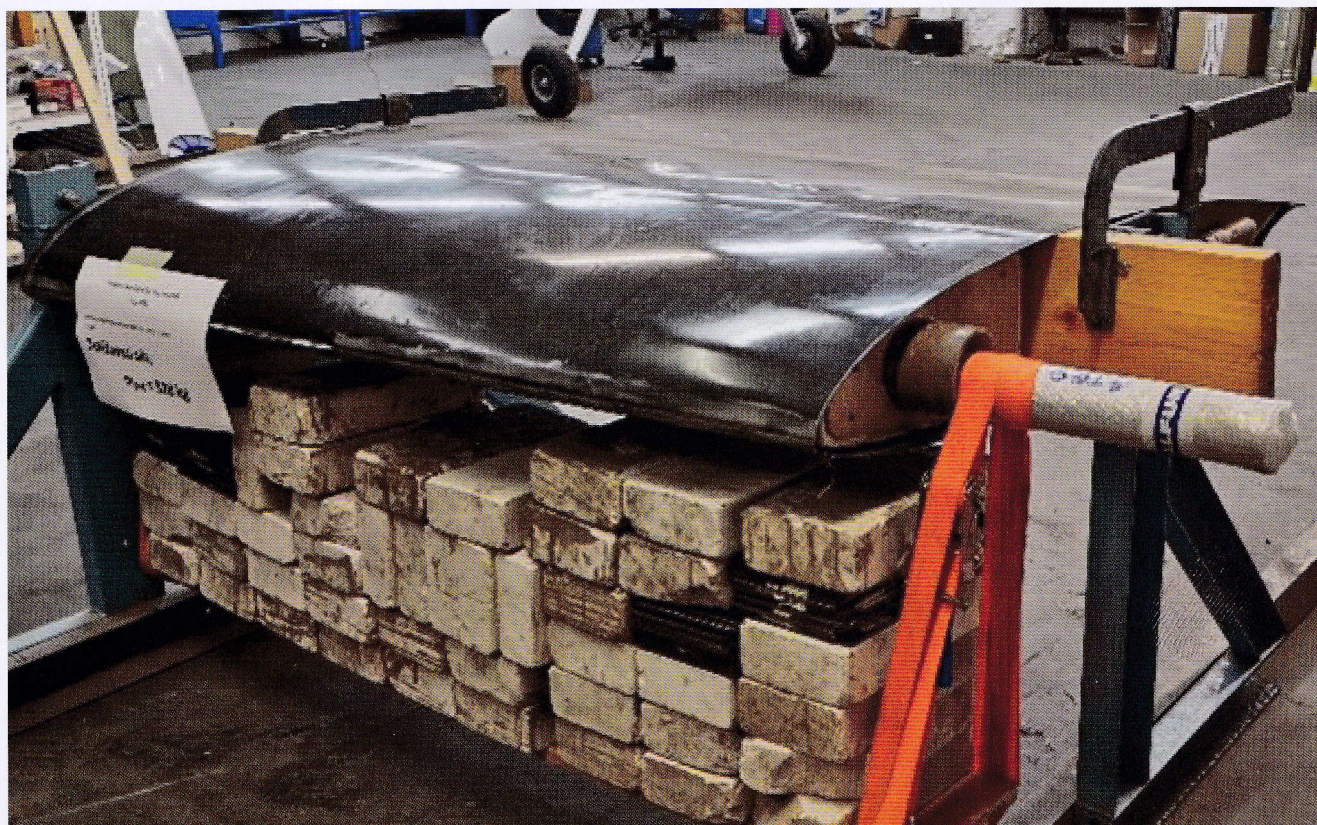
Til og med bensintanken – som ligger inne i vingene – testes. Her er den under en belastning på 328 kilo. Foto: Atec
