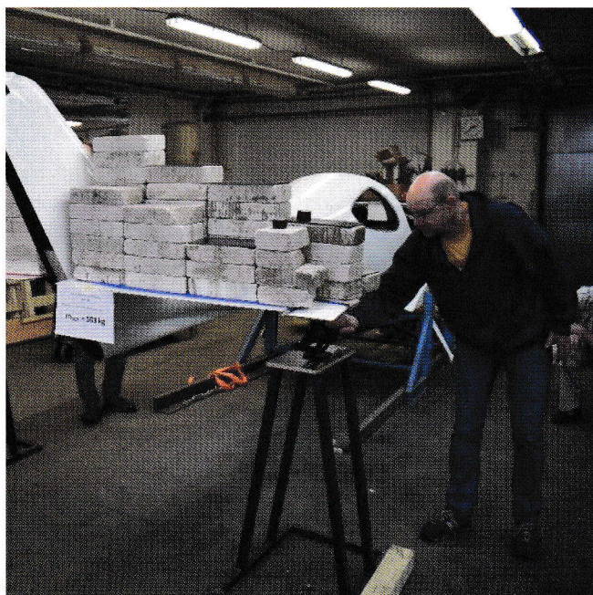
Haleflaten på testflyet Atec Faeta NG er belastet med 583 kilo. Som man ser, er haleflatene bøyd kraftig nedover. Foto: Atec
