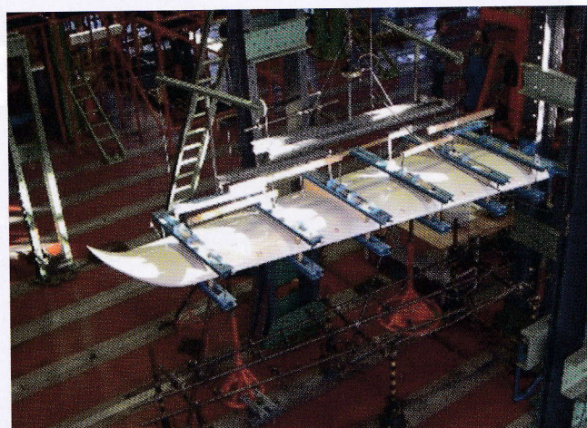
På bildet ser vi torsjonstest av vingen utført i Tyskland. Foto: Atec
