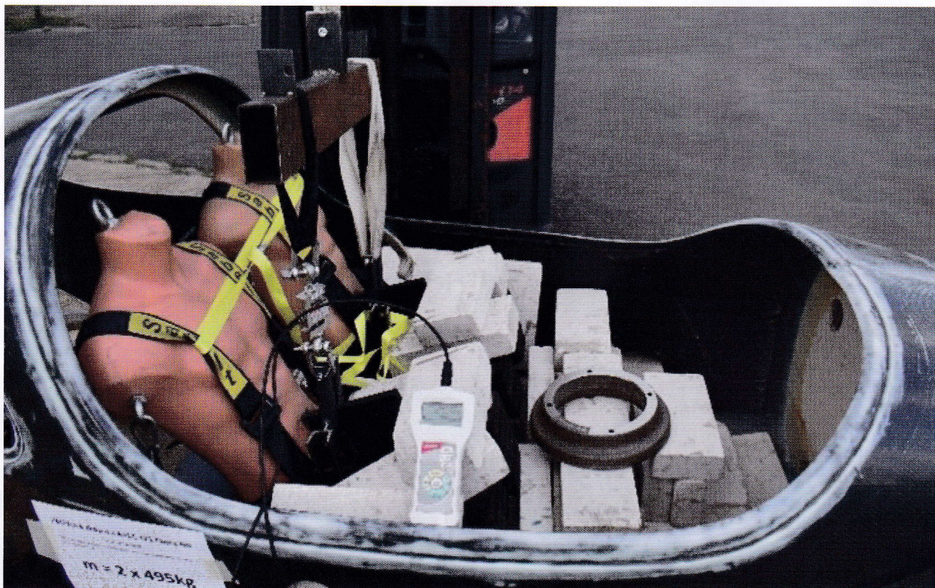
En vesentlig del av godkjenningen er tester av seter og setebelteinnfestning. Foto: Atec
